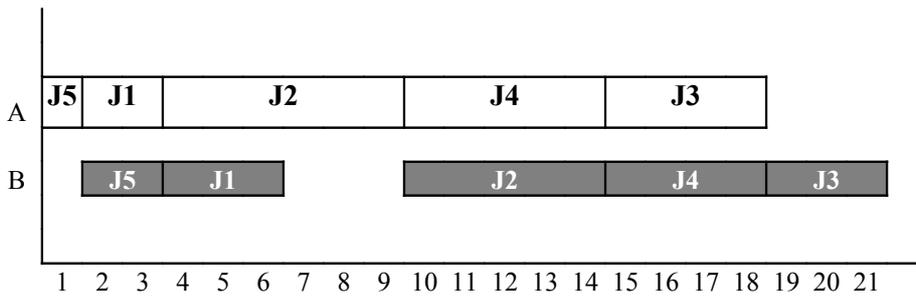
Il valore del makespan per la sequenza di job: J5, J1, J2, J4 e J3 risulta pari evidentemente a 21.
