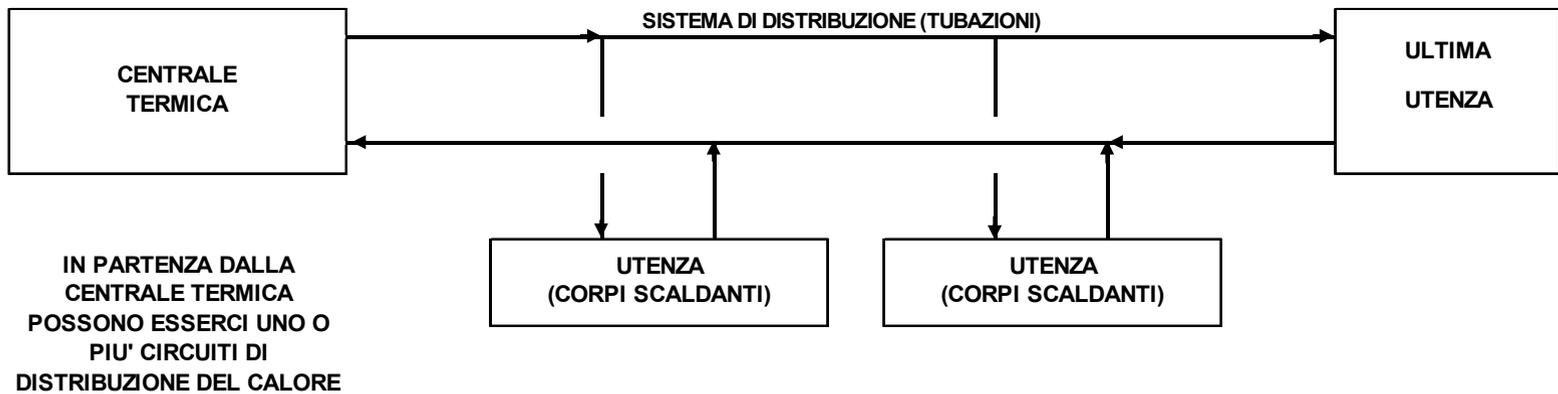
**SCHEMA A BLOCCHI DI UN IMPIANTO A CIRCUITO CHIUSO:
