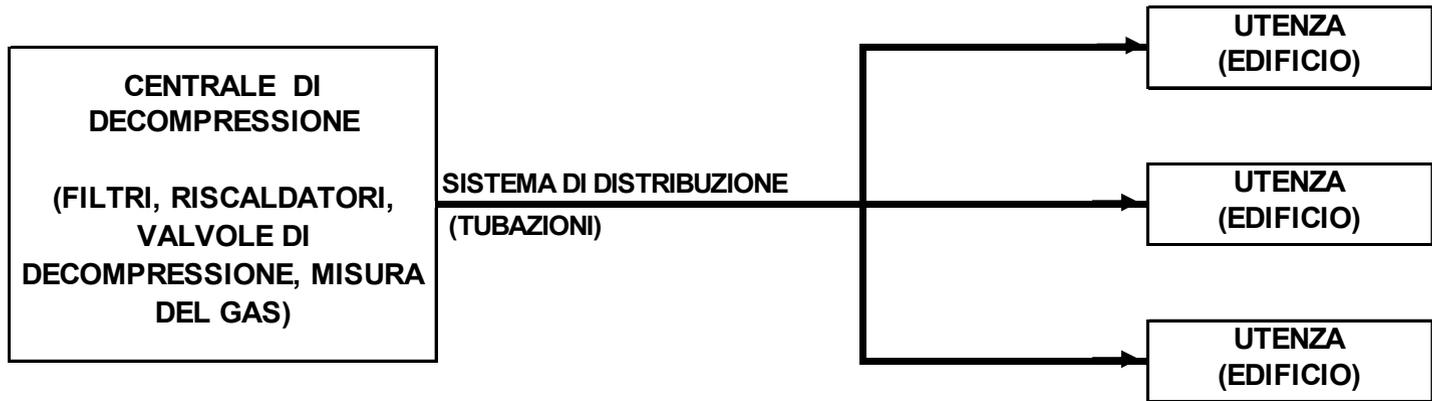
**SCHEMA A BLOCCHI DI UN IMPIANTO A CIRCUITO APERTO:
