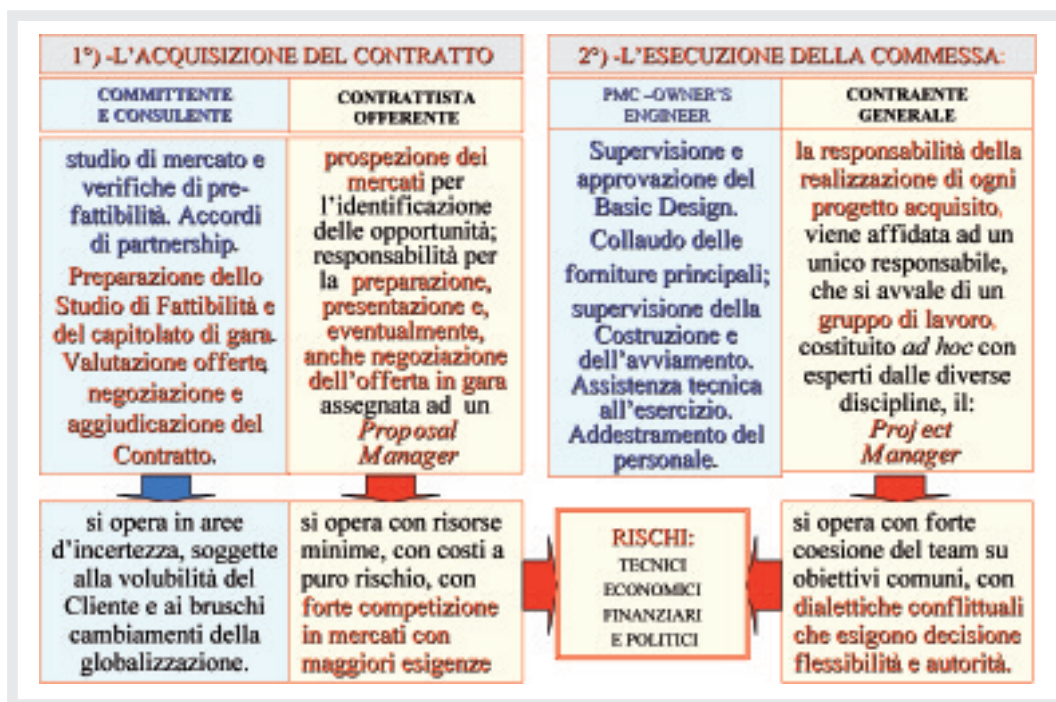
Fig. 1 - I ruoli di Proposal e Project Manager nell'acquisizione e nell'esecuzione di un progetto EPC
