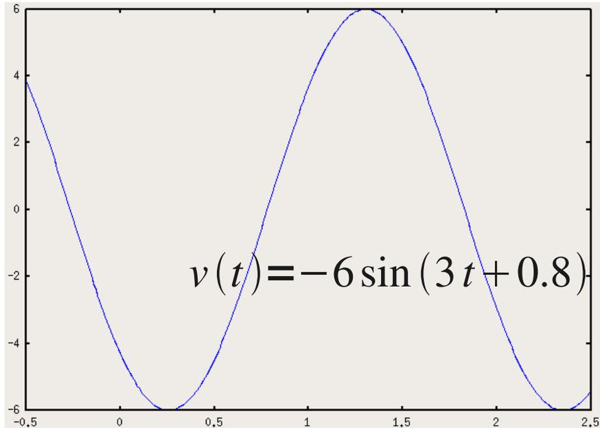
$\omega = 3 \text{ rad/s}$ ;  $f = 0.48 \text{ Hz}$ ;  $T = 2.09 \text{ s}$ ;
