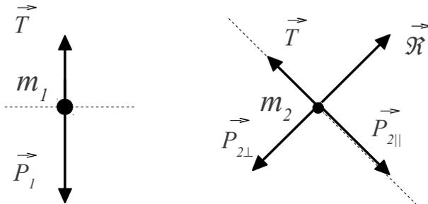
La reazione vincolare  $\mathcal{R}$  bilancia la forza peso perpendicolare  $\vec{P}_{2\perp}$  annullandone l'effetto. Le equazioni di Newton del sistema diventano:
