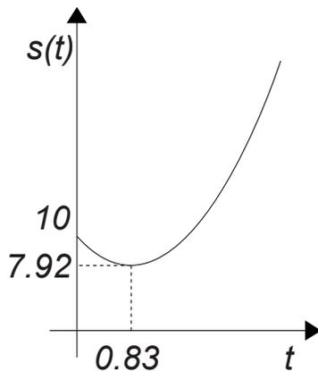
Poiché  $s(t)$  è un polinomio di secondo grado, esso rappresenta un moto uniformemente accelerato  $s(t) = s_0 + v_0 t + \frac{1}{2} a t^2$  in cui  $s_0 = 10 \text{ m}$ ,  $v_0 = -5 \text{ m/s}$  e  $a = 6 \text{ m/s}^2$ . La velocità istantanea  $v(t)$  si determina derivando la legge oraria  $s(t)$  rispetto al tempo
