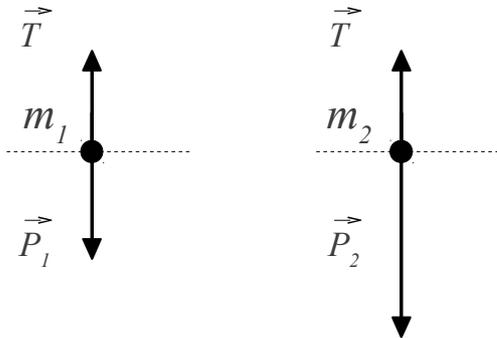
Tensione e forza peso, nel sistema 56 sono opposte in segno in quanto i vettori sono opposti, come mostrato nel grafico qui sopra. Il sistema si risolve sommando le due equazioni membro a membro, situazione nella quale scompare la tensione  $T$  e si può quindi determinare l'accelerazione  $a$ :
