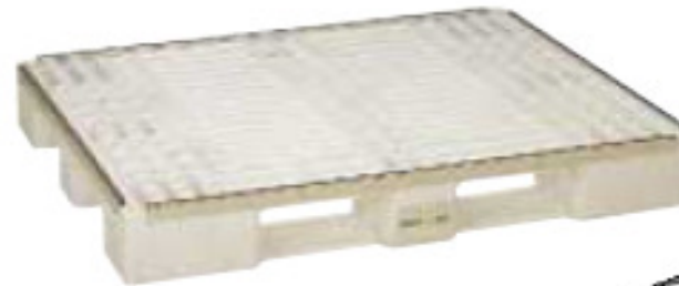
Art. F PU 2240 00 13 Pallets in plastica per cassette Alhena con bordi in acciaio zincato sui 4 lati Dim.: mm 1200x800x150h
