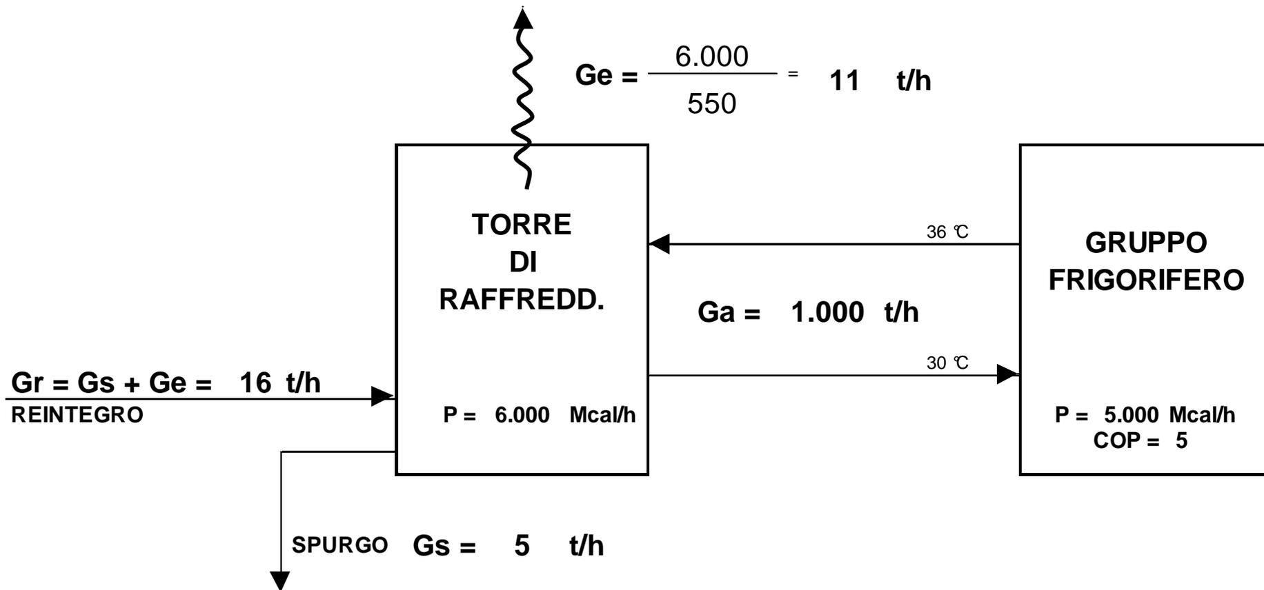
UNA PARTE DELL'ACQUA EVAPORA. QUESTA SI CALCOLA IN BASE AL CALORE LATENTE DI EVAPORAZIONE (550 kcal/kg). CON DT DI 5-6°C A CAVALLO DELLA TORRE, L'EVAPORATO E' CIRCA 1% DELLA PORTATA IN CIRCOLO
