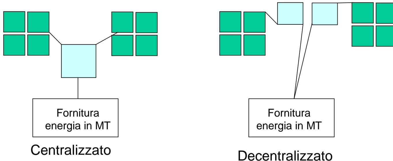
Al crescere del grado di centralizzazione, cresce la potenza che deve assicurare la cabina di trasformazione. Di conseguenza, i costi di impianto e di esercizio si modificano come indicato a seguire.
