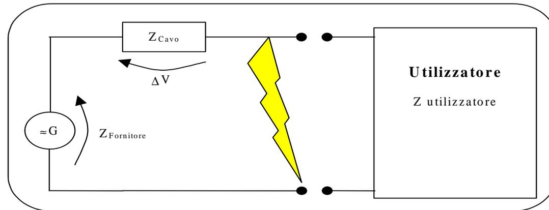
In questi casi, l'unica impedenza che trova il generatore è costituita dall'impedenza della linea, solitamente molto bassa. Il generatore, riversando sul circuito tutta la potenza di cui dispone, causa un drastico innalzamento delle correnti circolanti, con conseguente fusione delle guaine, azioni dinamiche tra cavi, ecc.
