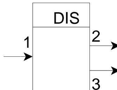
Stazione di disassemblaggio: vi si disassemblano due parti
