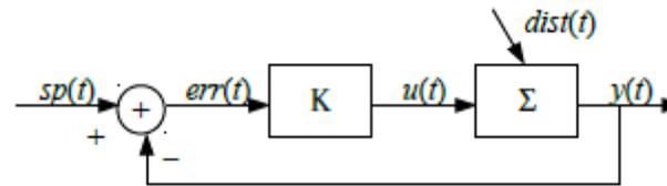
Le variabili di ingresso e di uscita per il sistema sono rispettivamente di uscita ed ingresso per il controllore quindi nel caso di assenza di disturbi e l'uscita  $y(t)$  dipenda solo dall'ingresso  $u(t)$  lo schema potrebbe essere rappresentato da una funzione identità con l'uscita uguale al set point:
