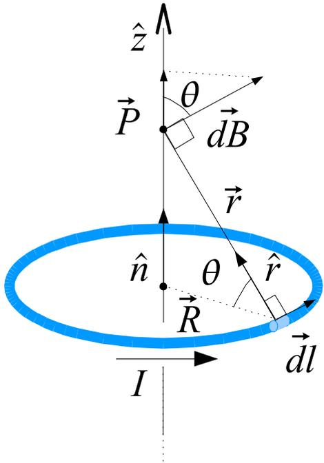
Partiamo dalla legge di Laplace e notiamo che il campo  $d\vec{B}$  è perpendicolare sia a  $d\vec{l}$  sia a  $\vec{r}$ , per cui ha andamento come in figura. Quando andiamo a sommare tutti i contributi della spira, notiamo che le componenti orizzontali di  $d\vec{B}$  si cancellano in quanto ad ogni direzione corrisponde una porzione di campo opposto, mentre quelle verticali si sommano. Per questa ragione andiamo ad integrare solo la componente di  $d\vec{B}$  lungo l'asse  $z$
