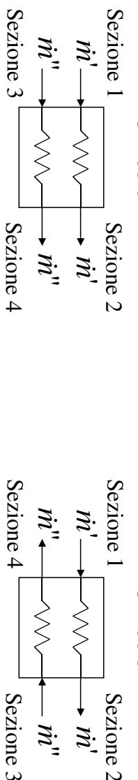
Equazioni di bilancio per lo scambiatore (equicorrente o controcorrente), trascrivendo gli scambi di calore verso l'esterno
